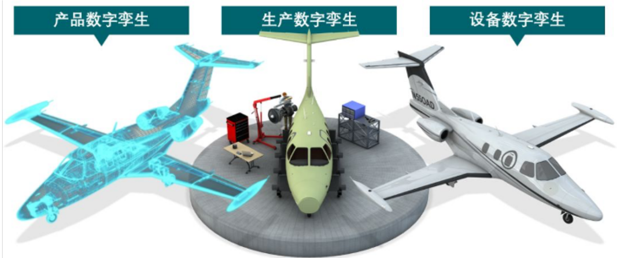
图2 产品/生产/设备三维数字孪生模型 [2]
